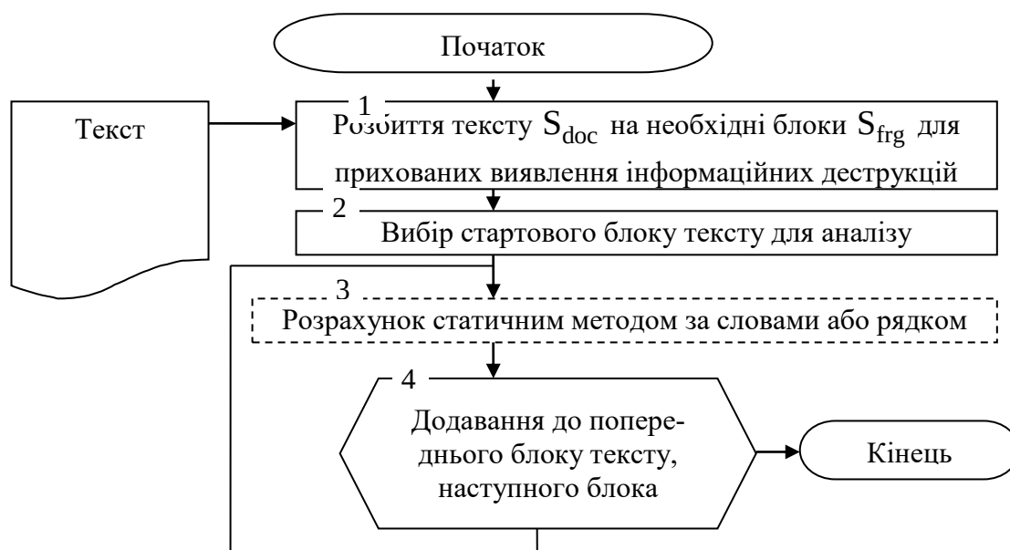
Рисунок 3.8 – Структурно-функціональна схема динамічного методу виявлення прихованих інформаційних деструкцій в AIR та TIR накопиченням фрагментів
