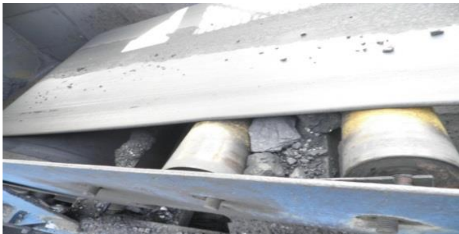
Рис. 2 – Сход ленты относительно продольной оси и ее трение о конструкцию рамы конвейера
