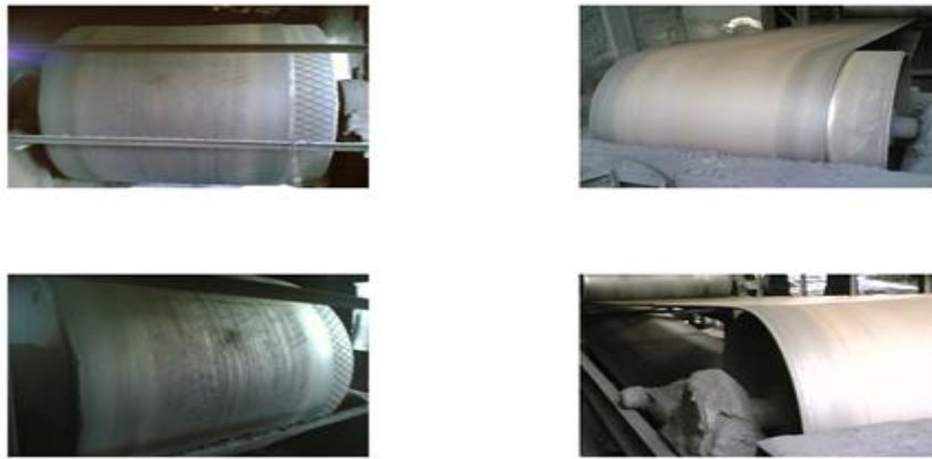
Рис. 1 – Сход ленты с приводного футерованного (слева) и натяжного (справа) цилиндрических барабанов
