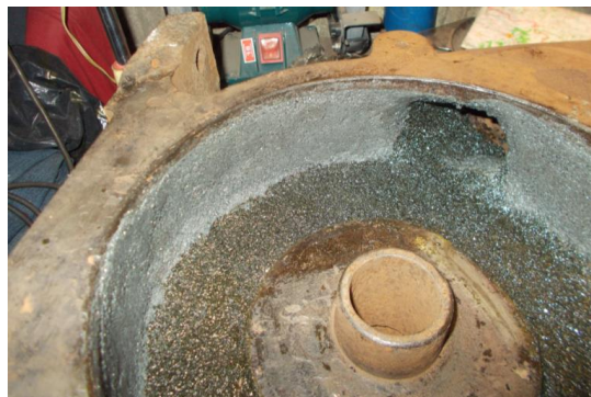
Рис. 2 – Изношенный корпус шламового насоса со слоем брони из абразивостойкого материала
