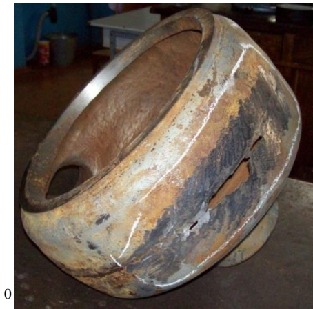
Рис. 1 – Корпус шламового насоса со сквозным дефектом
