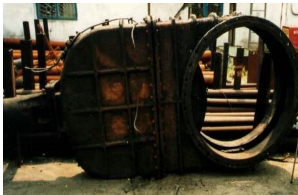
Рис. 4 – Общий вид шиберной задвижки ДУ 1000 с дефектом контактных поверхностей.
