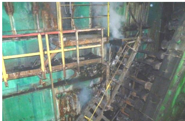
Рис. 2 – Результат коррозионного износа брони ручьев МНЛЗ
