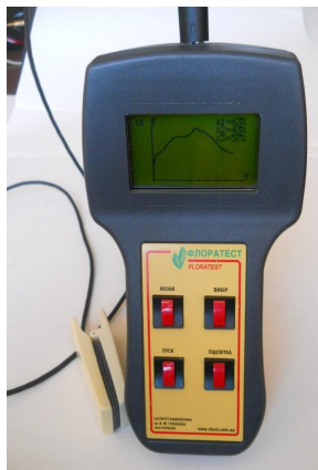
Рис. "Флоратест" - прилад для функціональної діагностики стану рослин в
