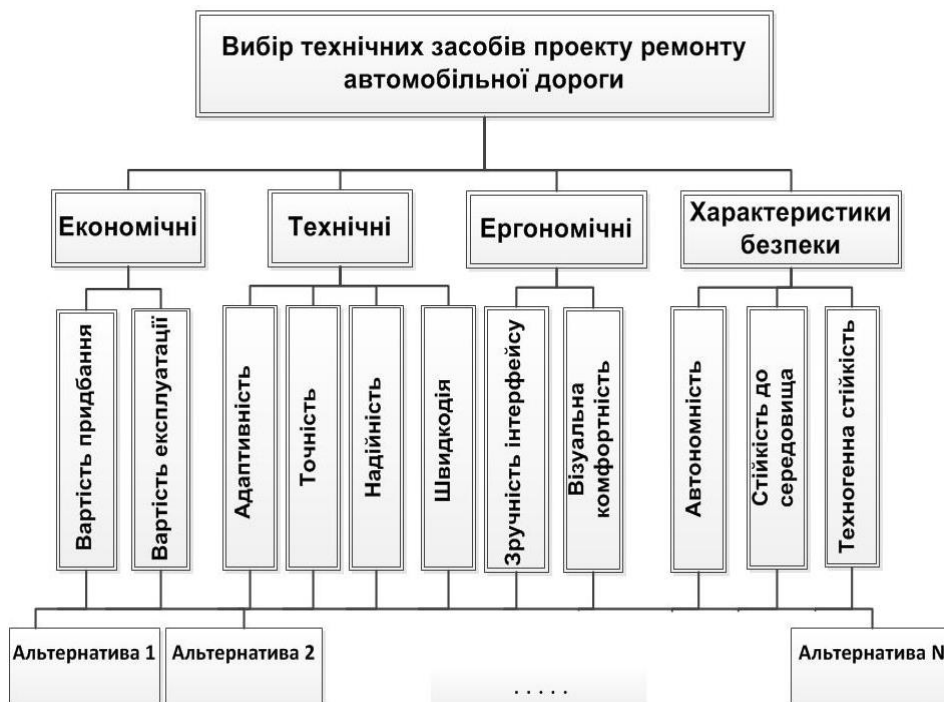
Рисунок. 1. – Ієрархічна структурна модель вибору технічних засобів проекту ремонту автомобільної дороги
