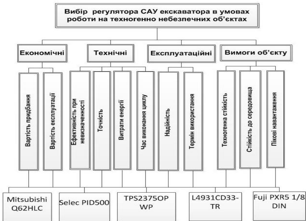
Рисунок. 1. – Ієрархічна структурна модель вибору регулятора САУ екскаватора в умовах роботи на техногенно небезпечних об'єктах
