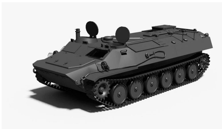
Рисунок 1 – базова 3D модель легкого багатогоцільового гусеничного транспортеру-тягачу МТ-ЛБ.
