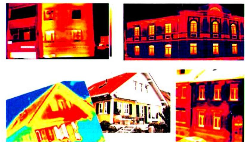
**Рис. 17** Визначення зон витоків тепла і місць значного перегріву фасадів будівель
