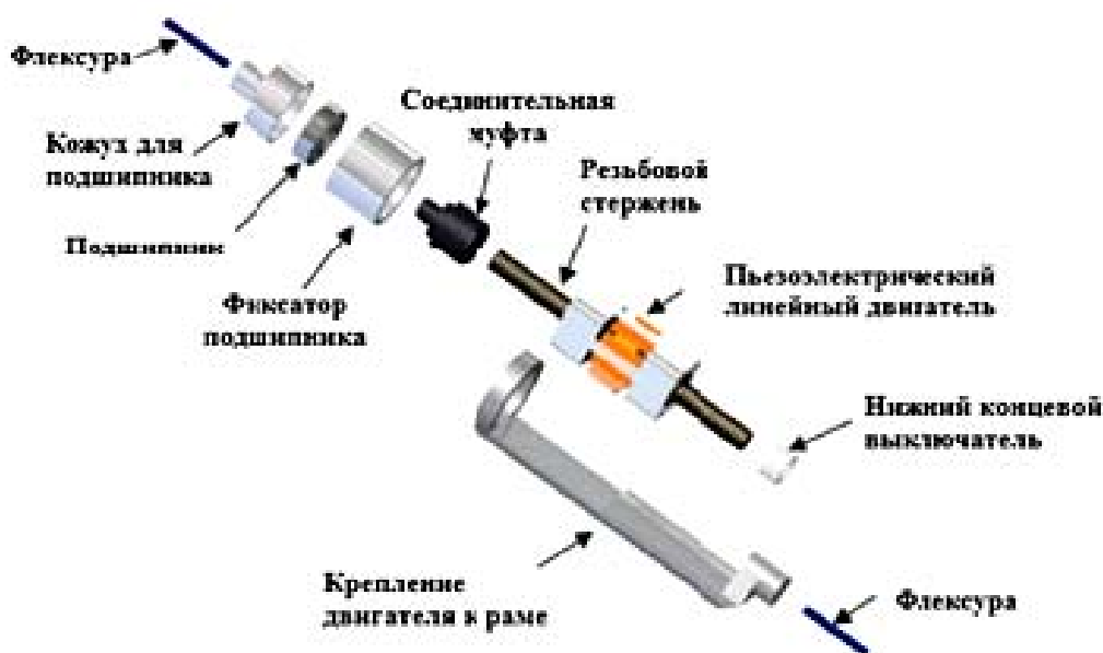
Рис. 3. Строение ножки микроманипулятора
