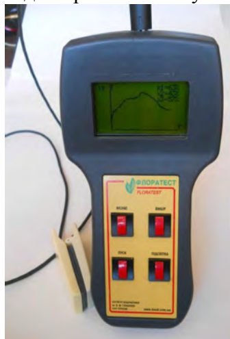
Рис. 3. "Флоратест" - прилад для функціональної діагностики стану рослин в польових умовах.
