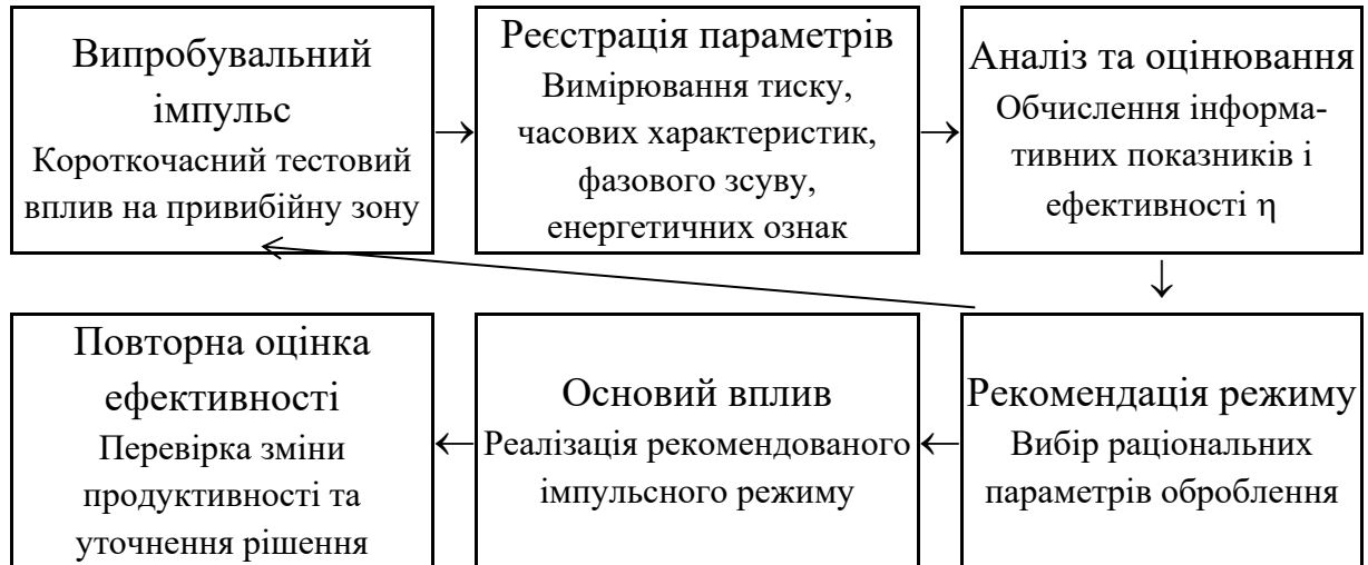
Рисунок 4.12 – Узагальнена схема промислового використання ІВС.
