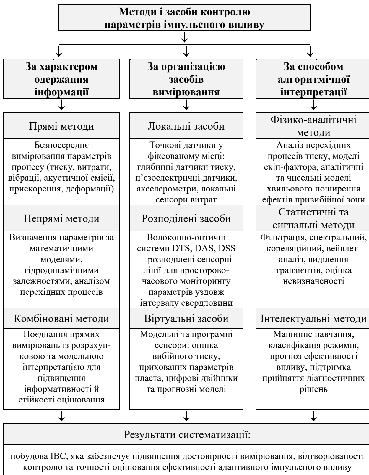
Рисунок 1.8 – Класифікація методів і засобів контролю параметрів імпульсного впливу та реєстрації реакції пласта. Джерело: складено автором за [60–62, 67]
