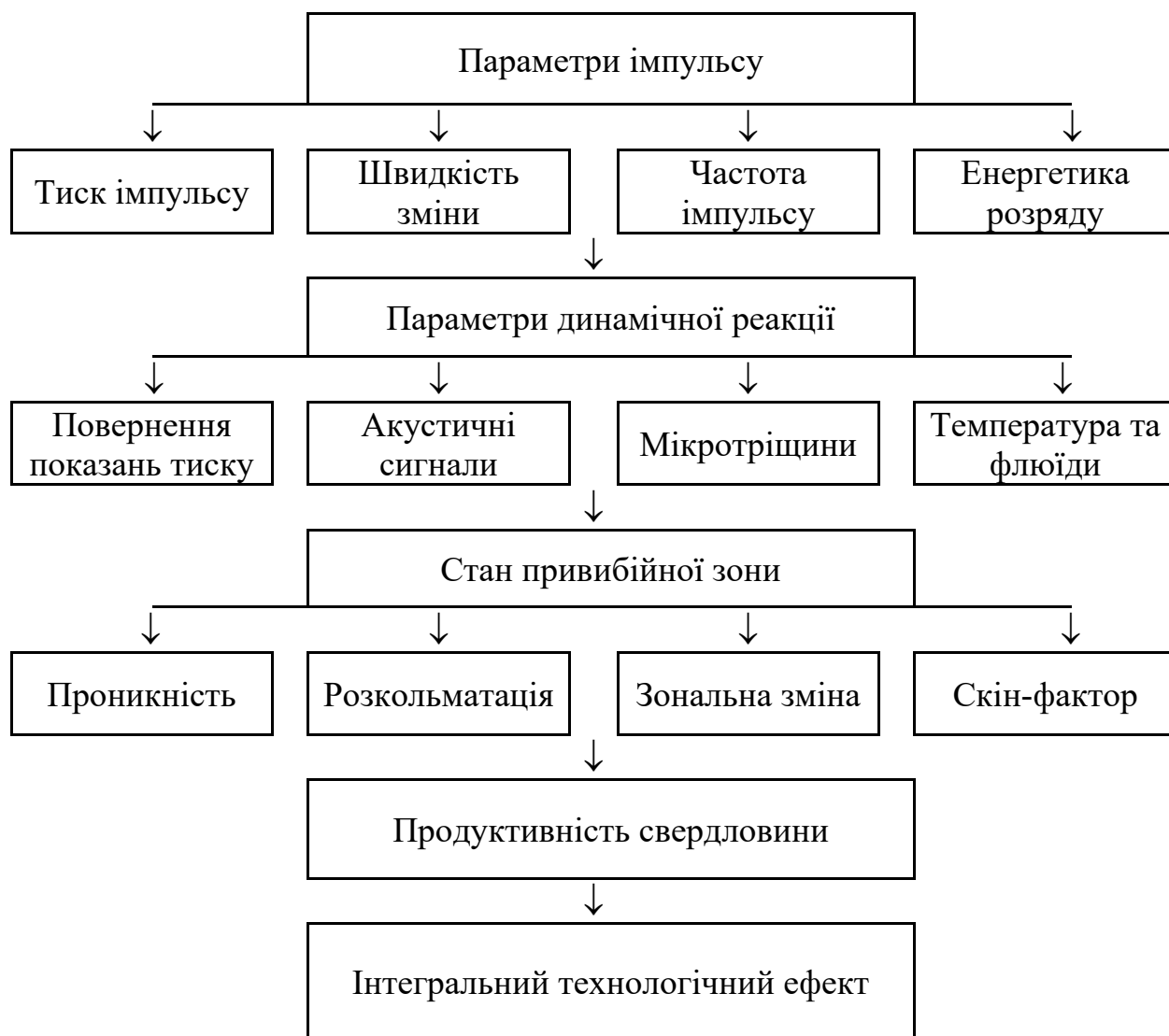
Рисунок 1.15 – Ієрархія критеріїв оцінювання ефективності імпульсного впливу. Джерело : складено автором за [121–134].
