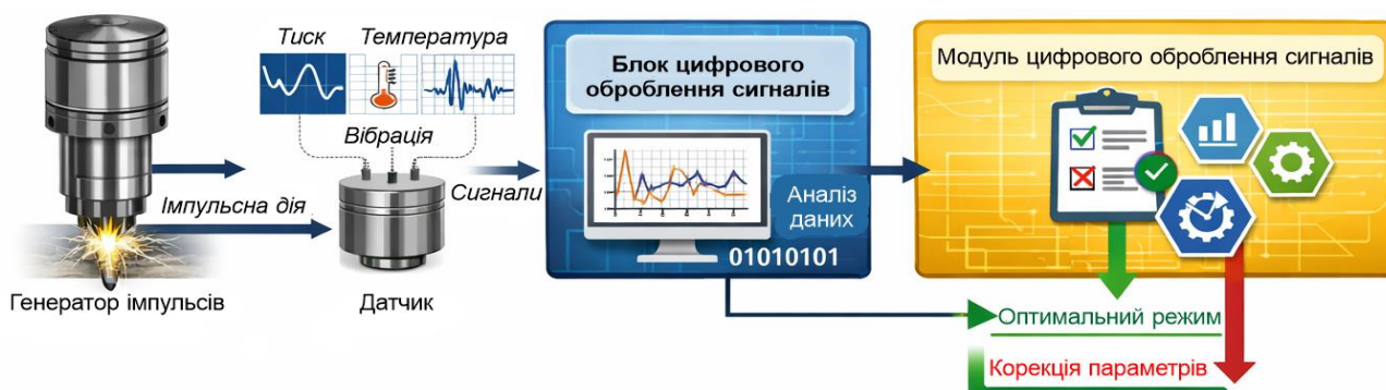
Рисунок 1.6 – Контур адаптивного імпульсного впливу: «формування імпульсу – вимірювання параметрів – інтерпретація реакції пласта – корекція режиму». Джерело : складено автором за [37, 40, 45, 55] з графікою, побудованою із залученням великої мовної моделі ChatGPT 5.5.
