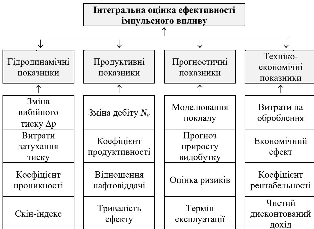
Рисунок 1.12 – Багатокритеріальна схема інтегрального оцінювання ефективності імпульсного впливу. Джерело: складено автором за [80, 83, 86, 98, 99]
