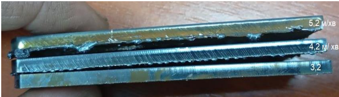
Рисунок 4.3 – Зразки з 3 мм Ст3, порізані на потужності 12 кВт на різних швидкостях
