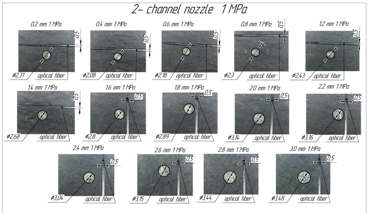
Рисунок 2.4 – Результати визначення величини діаметра струменя асистуючого газу в середовищі САПР
