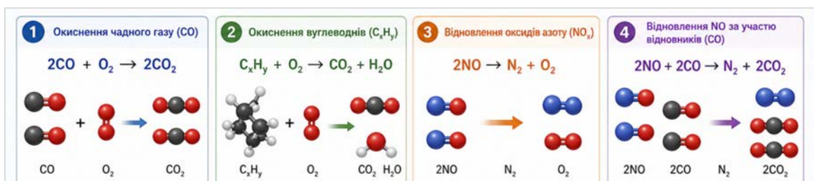
Рисунок 2. Основні хімічні процеси в каталізаторі
