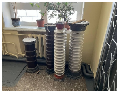
Рисунок 1. Відпрацьовані високовольтні ізолятори
